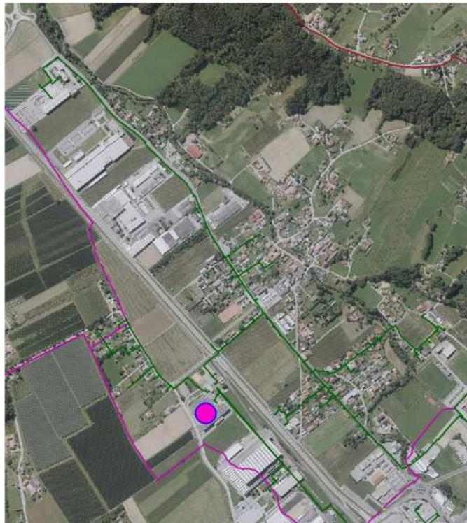
Abbildung 66: Fernwärmenetz Preding mit Standort Heizwerk, Quelle: W.E.I.Z. Innovationszentrum
